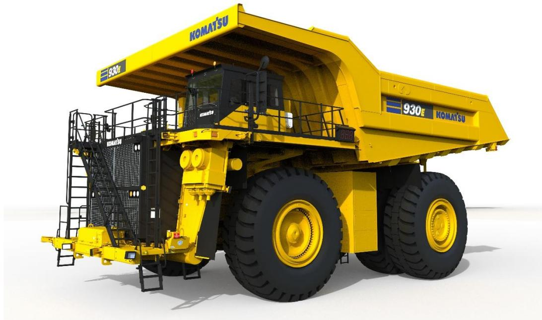
*Le tombereau 930E destiné à l'extraction sera alimenté par des piles à combustible HYDROTEC.*
