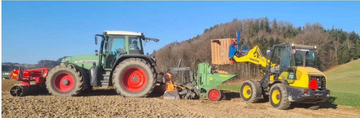
Bild 1: Der Komatsu WA70M-8 mit Drehgerät beim Befüllen der Kartoffelsetzmaschine.
