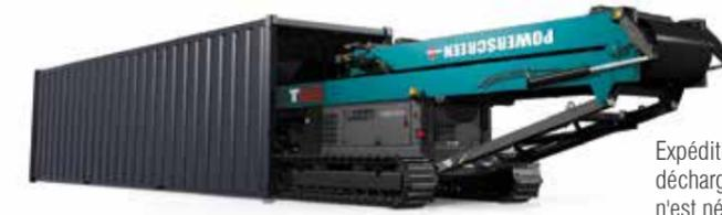
Expédition en conteneur, chargement et déchargement sur chenilles. Aucune grue n'est nécessaire.
