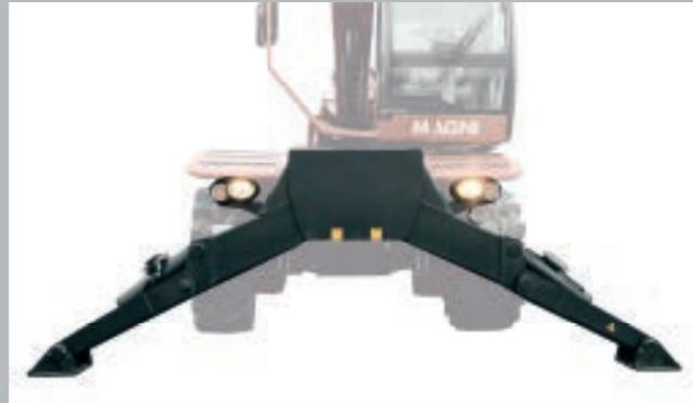
Les dimensions réduits du châssis sont accentuées par les stabilisateurs pivotants qui sont réalisés sur le même essieu. Lorsque les stabilisateurs sont rentrés, ils s'adaptent parfaitement à la forme de la machine et ne réduisent pas la garde au sol.
