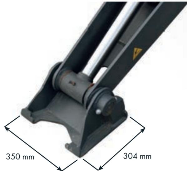
Le processus de levage et d'abaissement des stabilisateurs permet une adaptation optimale vers tous types de sol grâce à leur large surface. Il permet également la fermeture automatique des pieds des stabilisateurs dans le profil de la machine.
