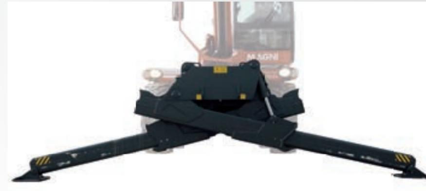
Les stabilisateurs à ciseaux restent parfaitement dans le profil de la machine lorsqu'ils sont fermés et leurs poutrelles superposées, fixées sur le châssis, n'affectent pas la garde au sol. Les stabilisateurs peuvent être gérés simultanément ou individuellement pour s'adapter parfaitement au lieu de travail.
