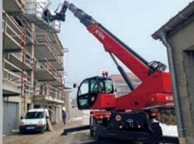
Les stabilisateurs pivotants et ceux à ciseaux ils sont excellentes pour travailler sur les sites les plus confinés. Les premiers grâce à la zone de stabilisation très compacte et les derniers grâce à leur flexibilité. Ils peuvent en effet s'adapter aux besoins du conducteur ou aux conditions de l'espace de travail.
