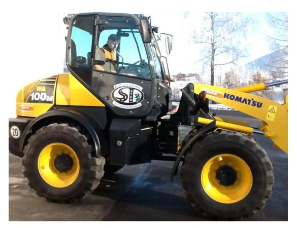
Der Radlader WA100-5 von Komatsu überzeugt durch seine kompakten Abmessungen wodurch er auch in Engstellen leicht einsetzbar ist.
