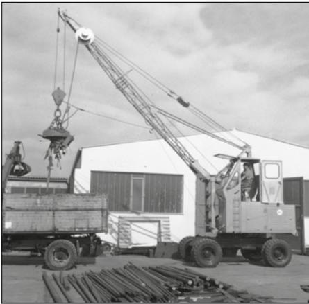
1962: Seilbetriebener S833 mit erhöhter Fahrerkabine
