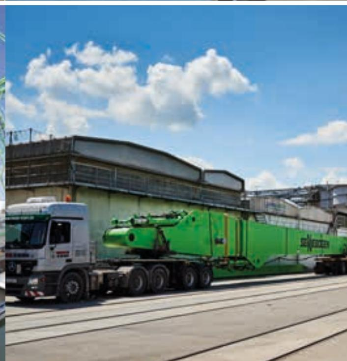
Für den späteren Einsatz im größten Schwarzmeerhafen Bulgariens, in Burgas, bekam der 8400 einen Schienenportal-Unterwagen. Die gesamte Maschine kann entlang des Hafenbeckens verfahren und LKWs fahren zur Beladung einfach unter der Maschine hindurch.
