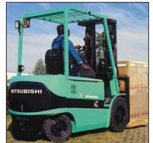
Ob Sie sich für 3 oder 4 Räder entscheiden, es kommt überall dieselbe fortschrittliche Technik zum Einsatz. Luftbereifte 4-Rad-Elektrostapler gibt es mit Kapazitäten von 1,6 bis 2,0 und von 2,0 bis 3,5 sowie von 4,0 bis 5,0 Tonnen. Die Bandagen-Modelle bieten Tragfähigkeiten von 1,5 bis 3,0 Tonnen.
