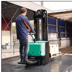
Innerhalb der Hochhubwagen-Serie werden Sie Kapazitäten bis 2,0 Tonnen mit maximaler Hubhöhe von 6,3 Metern finden. Auch hier haben Sie die Wahl zwischen Mitgänger-, Plattform-, Fahrerstand- und Fahrersitzmodellen, je nach Ihrem Bedarf.
