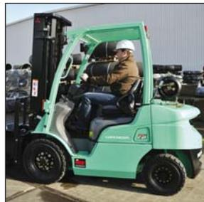
Die hochentwickelte Motor-technologie unserer Treibgasstapler zusammen mit dem fortschrittlichen Design eines jeden Bestandteils und Systems liefern hohe Leistung bei niedrigen Emissionen. Die luftbereiften Modelle reichen von 1,5 bis 5,5 Tonnen während mit Bandagen Kapazitäten von 2,0 bis 3,3 und von 3,5 bis 7,0 Tonnen verfügbar sind.
