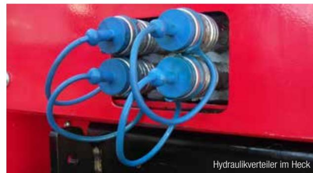
Hydraulikverteiler im Heck
