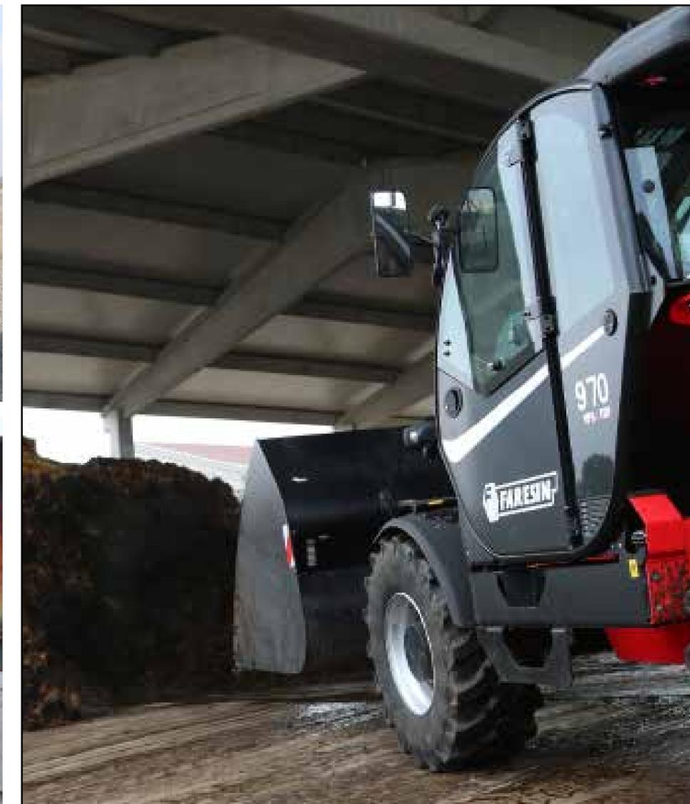
Dank der vorderen Abstützungen und der Seitennivellierung ist die Big-Range-Baureihe von Faresin die erste Wahl für den Materialumschlag auf dem Bau. Die Armkonstruktion mit zwei (14 m-Ausführungen) oder drei (17 m-Ausführungen) Segmenten ist dank externem Zylinder besonders vielseitig und extrem wartungsfreundlich. Schallgeschützte King-Cab-Kabine mit ROPS/FOPS-Zulassung, Heizung und Lüftung, elektroproportionaler Joystick.
