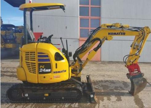
Schutzdach, 2 Hydraulikkreise proportional, Schnellwechslerkreis, PT-Umschaltung elektrohydraulisch, Powertilt mit HS03-DL, 1 Humuslöffel, 1 Tieflöffel
