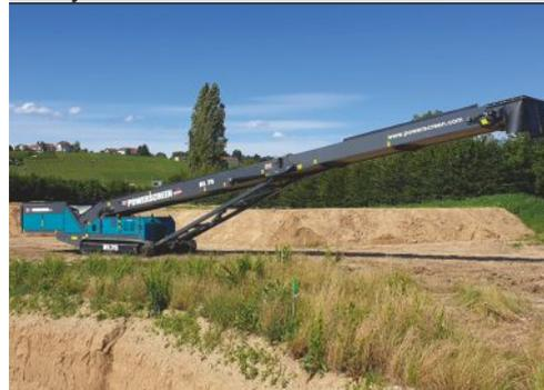
Trichterhöhung 700 mm, Förderbandwiegesystem Pfreundt, T4f Motor mit aufgebautem DPF, max. Förderleistung 600 t/h, max. Abwurfhöhe 9.8 m
