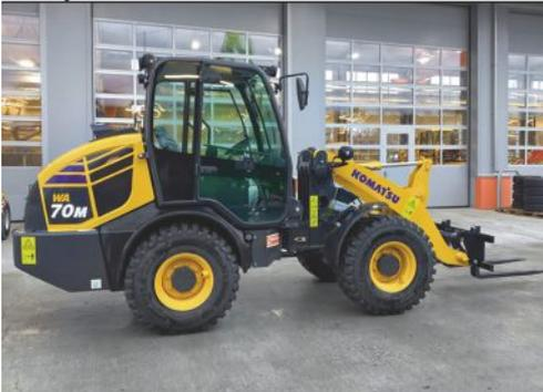
Schaufel 0.85 m³, ohne Zähne, Staplergabel, hydr. Schnellwechsler, hydrostatischer Fahrantrieb 20 km/h, Kippkabine
