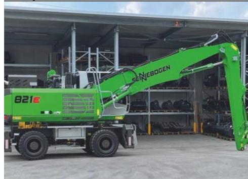
Hochfahrbare Komfortkabine Heizung/Klima, Ausrüstung K11 ULM, Greifer SGR-1000, Fremdstartpole, SENTrack, Vollgummibereifung UW MP21, Dachfenster Panzerglas, 3 LED Stiel und Ausleger
