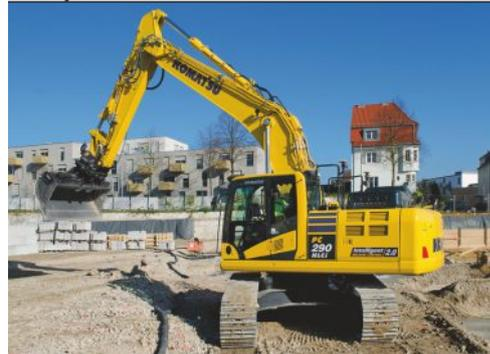
Kabine Heizung/Klima, Monoblockausleger, 3-Steig Bodenpl. 600 mm, Schnellwechsler HS25DL, Böschungslöffel, Tieflöffel, IMC 2.0 (3D), Zentralschmieranlage, Leckölleitung
