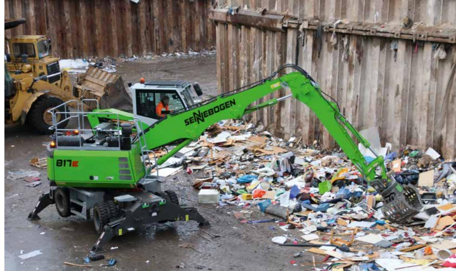
817E - moderno escavatore per la movimentazione dei materiali per lavori di smistamento rapidi e accurati nel settore del riciclaggio dei rifiuti
