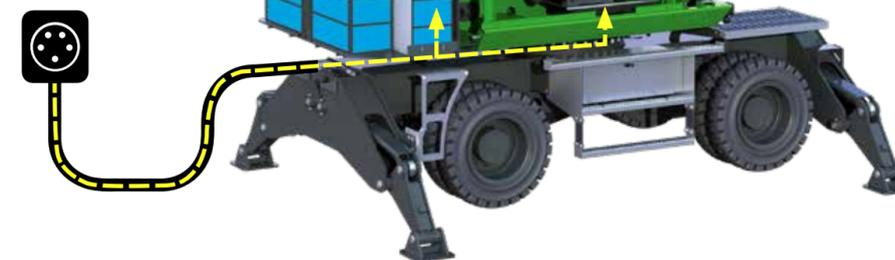
Allacciamento elettrico ad alta tensione sul carro. La torretta e l'attrezzatura possono funzionare liberamente. L'alimentazione in eccesso, nel frattempo, ricarica la batteria.
