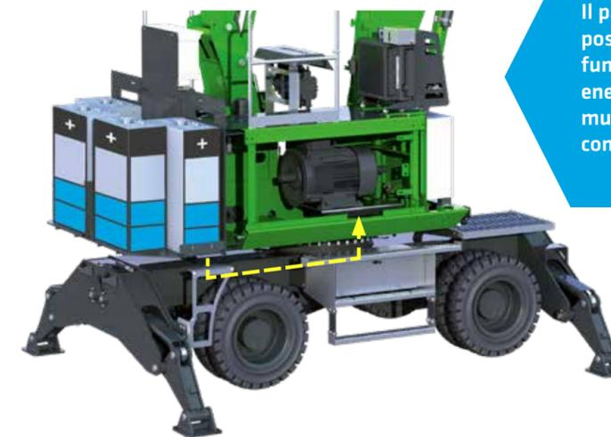
Il pacco batterie nella parte posteriore della macchina funge da unica fonte di energia. La macchina si muove e funziona in modo completamente autonomo.
