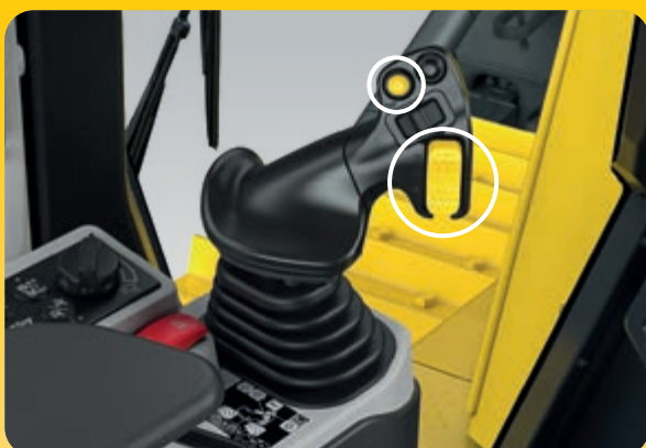
Commande de déplacement PCCS avec nouvel interrupteur avant-neutre-arrière et bouton de commande du klaxon intégrés
