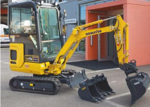
Cabine avec chauffage, chenilles en caoutchouc, 1 circuit prop. hydraulique, attache rapide mécanique Powertilt MS01, godet à humus, 2 godets rétro
