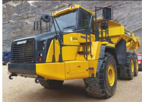
Capacité 24.4 m³, charge utile 40 t, hayon arrière, chauffage de benne, moteur Komatsu stage V 353 kW, pneus Michelin 29.5-R25, boîte de vitesses entièrement autom., traction intégrale permanente,
