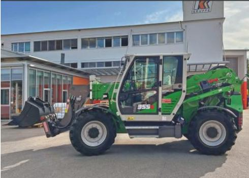
Fourche à palettes 5.5 t, transmission continue 40 km/h, dispositif de conduite lente, système de caméra, suspension bras, retour automatique du godet, fonction permanente ZH1, cabine relevable
