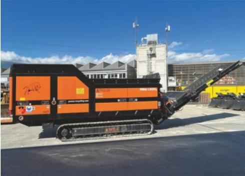
Train de chenilles, moteur stage V, 405 kW, arbre 3000 x 970 mm, équipé de 42 dents vissées, contre-peigne, ventilateur hélicoïdal, séparateur magnétique, télécommande radio, graissage centralisé
