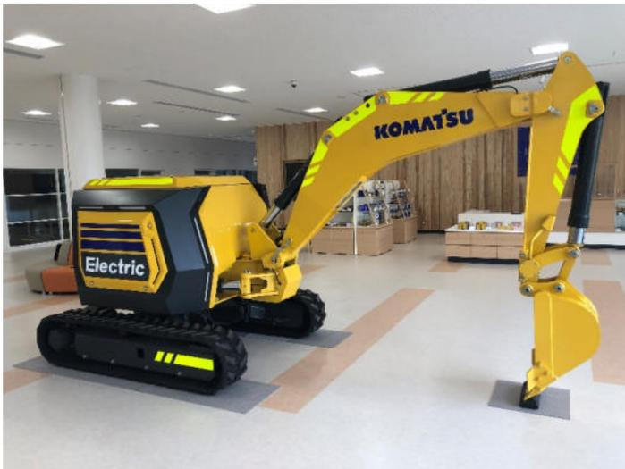
La mini-pelle 100% électrique : nouvelle génération d'engin pour les chantiers de demain
