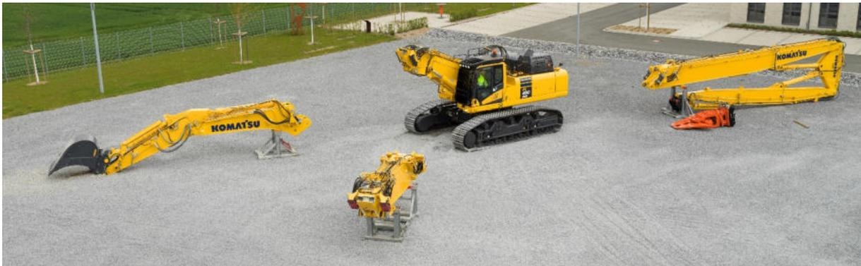
Au total, six configurations sont possibles pour les travaux à grande hauteur, privilégiant tantôt la portée avec une extension à 32 m, tantôt la puissance à 28 m de haut. La machine permet aussi les portées moyennes avec l'exploitation de l'équipement d'excavation. La PC490HRD propose déjà un large éventail de configurations pour prendre en charge n'importe quel projet de démolition.
