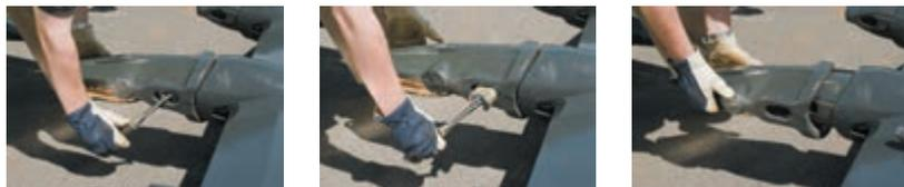
1. Déverrouillez la tige de verrouillage en la tournant de 90° à l'aide d'une clé à douilles
