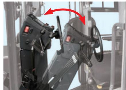
*Réglez le volant à la position la plus confortable*
