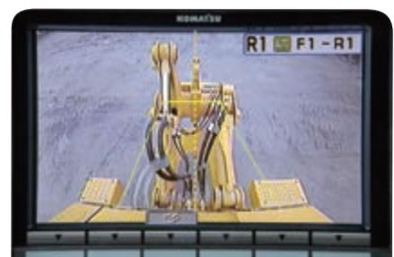
Système de caméra vue arrière complètement intégré
