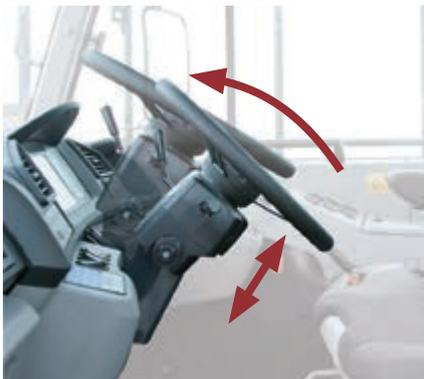
Réglez le volant à la position la plus confortable.
