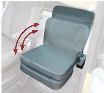
L'instructeur dispose d'un siège à part entière, équipé d'un coussin et d'un dossier escamotables pour dégager l'accès à la cabine, ainsi qu'au filtre de la climatisation et à la boîte à gants.
