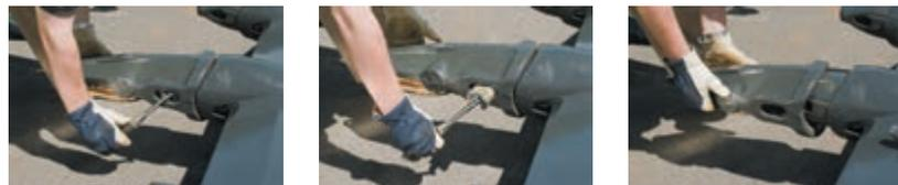
1. Rilasciare l'albero del perno di fissaggio ruotandolo di 90° con una chiave a bussola
