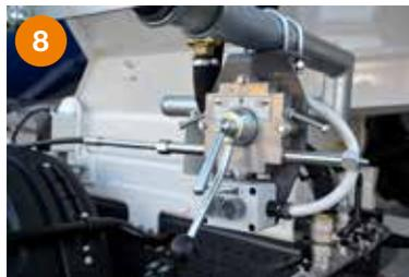
8 Manuelles Kontrollsystem mit Bowdenzügen (für die Grundversion des Fahrmischers).
