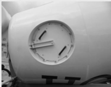
Schnellriegelungsklappe für eine einfache Wartung der Trommel.
