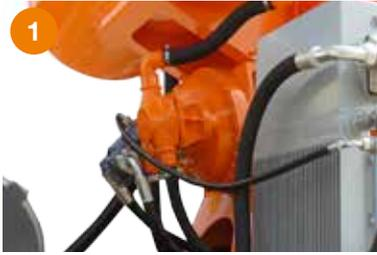
1 Am Trommelgetriebe angeschlossene Wasserpumpe.
