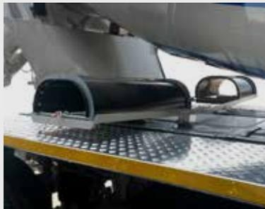
In einem Winkel von 90° angebrachte Spezialstütze für Schurren unter der Trommel.
