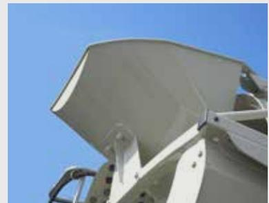
Einfülltrichter mit gerader Rückseite.
