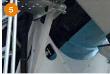
5 Trommelsicherheitsstopp für die Wartung des Fahrmischers und die rückseitige Abdeckung aus Kunststoff.
