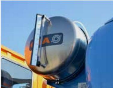
Wasserdruckbehälter aus Aluminium (Kapazität von 200 bis 950 Liter).
