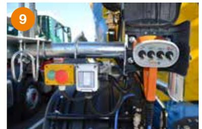
9 Elektronisches Kontrollsystem. CSD-Steuerung (Constant Speed Drive) (für die CSD-Version des Fahrmischers).
