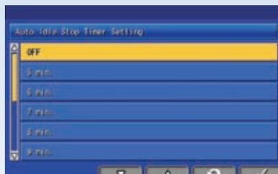
Die anpassbare Leerlaufabschaltung schaltet den Motor nach einer einstellbaren Zeitspanne im Leerlauf automatisch ab. Wenn sich die Bedienhebel für eine vordefinierte Zeit in Neutralstellung befinden, reduziert die neue Drehzahlabsenkung zusätzlich automatisch die Motordrehzahl.
