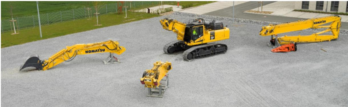
Mit insgesamt sechs Arbeitskonfigurationen, darunter der 32 m lange „Extended High Reach“- Ausleger, der leistungsfähige 28 m „High Reach“-Ausleger, der „Medium Reach“- und der Grabausleger, bietet der PC490HRD-11 bereits ein vielseitiges Spektrum von Konfigurationen für unterschiedliche Abbruchprojekte.
