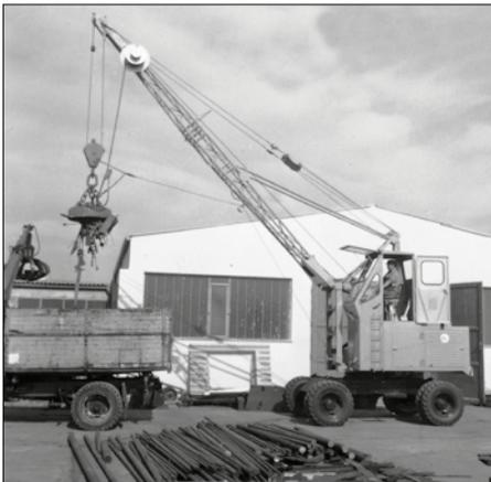
1962: Seilbetriebener S833 mit erhöhter Fahrerkabine
