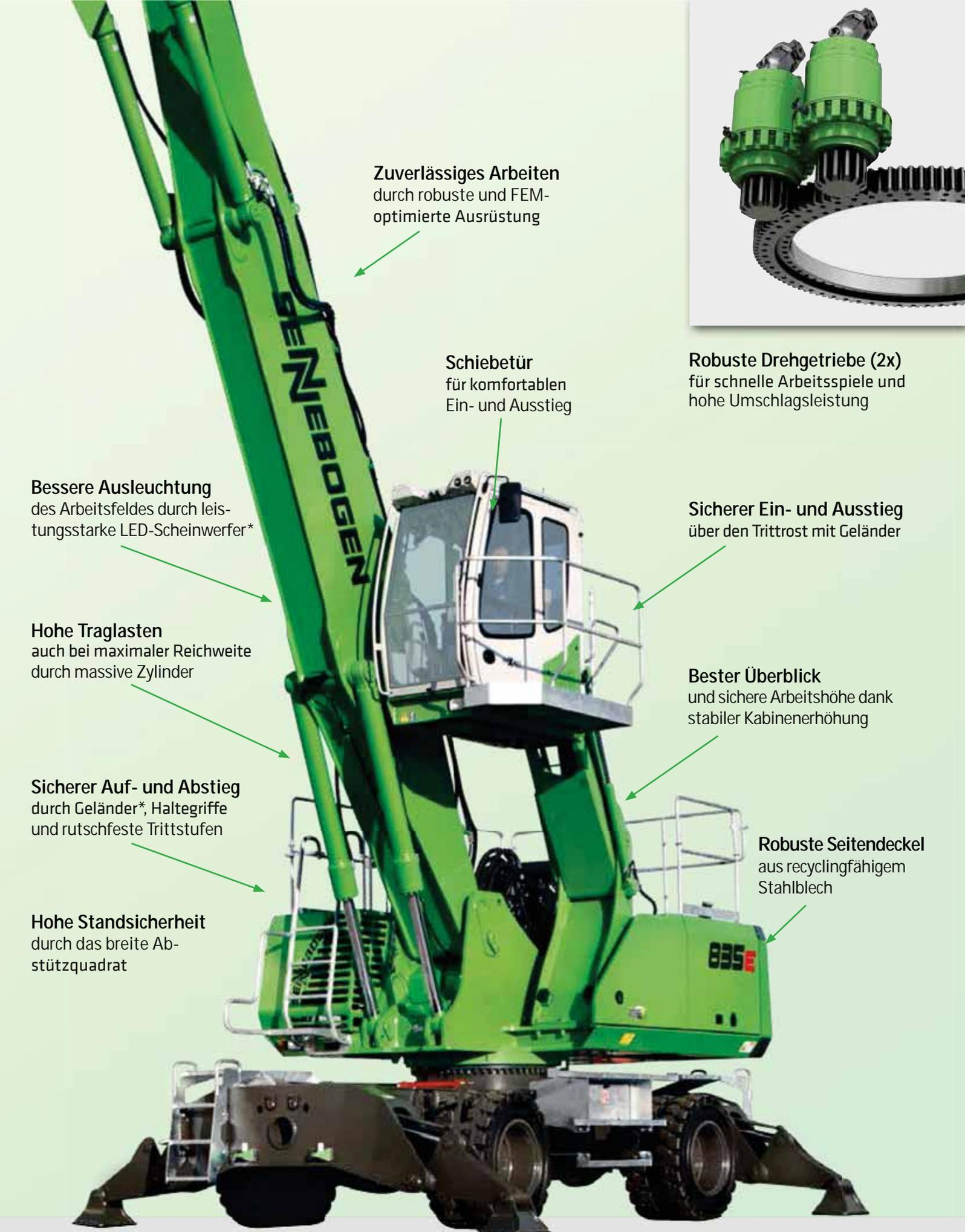
Zuverlässiges Arbeiten durch robuste und FEM-optimierte Ausrüstung
