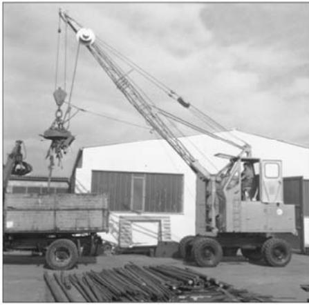
1962: Seilbetriebener S833 mit erhöhter Fahrerkabine
