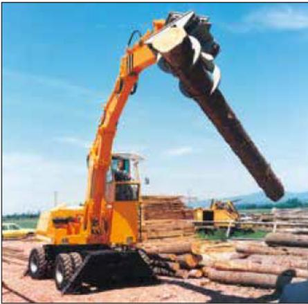
1974: Holz-Umschlagmaschine mit erhöhter Fahrerkabine
