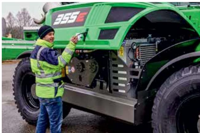
Mit einem Handgriff geräumiger Zugang zum Motorraum.
