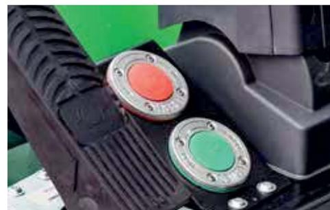
Bequeme Fußpedale zur stufenlosen Höhenverstellung der Kabine
